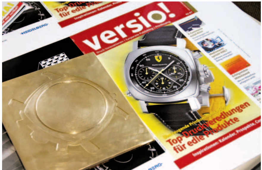
Rechts der lackierte Bogen, links das von einem Graveur erstellte Prägewerkzeug.
